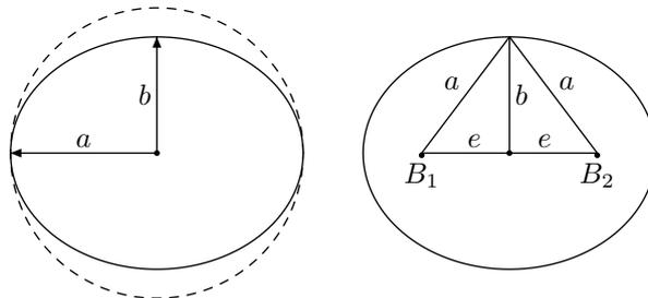
Ein hilfreiches Maß für den Grad der Stauchung ist die Exzentrizität  $e$ , die  $a$  und  $b$  geometrisch als Längen von Hypotenuse und Kathete eines rechtwinkligen Dreiecks ins Verhältnis  $e^2 = a^2 - b^2$  setzt. Über die Exzentrizität werden zwei Punkte der Hauptachse ausgezeichnet: die Brennpunkte  $B_1$  und  $B_2$ , welche den Abstand  $e$  zum Mittelpunkt haben.
